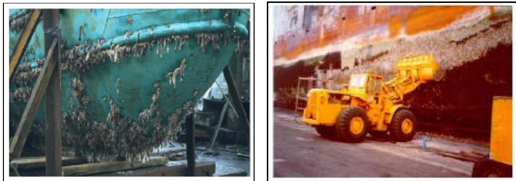
Figura 2 - Exemplos de cascos de navios com elevado grau de incrustação [1].
