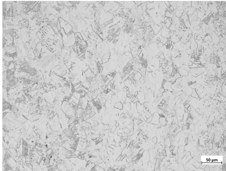
Figura 4.9 Amostra da região central do corpo de prova de aço inoxidável austenítico AISI 304 para 10% de deformação. Ataque eletrolítico com ácido oxálico 10%. Aumento: 200 X.
