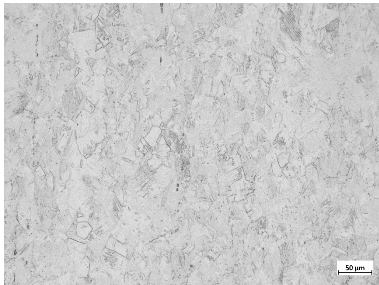
Figura 4.10 Amostra da região central do corpo de prova de aço inoxidável austenítico AISI 304 para 25% de deformação. Ataque eletrolítico com ácido oxálico 10%. Aumento: 200 X.
