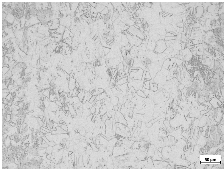
Figura 4.8 Amostra da região central do corpo de prova de aço inoxidável austenítico AISI 304 na condição de como recebido. Ataque eletrolítico com ácido oxálico 10%. Aumento: 200 X.
