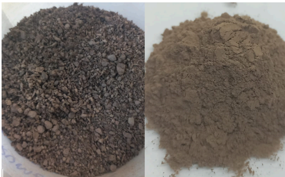
Figura 2: Lodo seco antes e depois de passar pela peneira Tyler 200.
