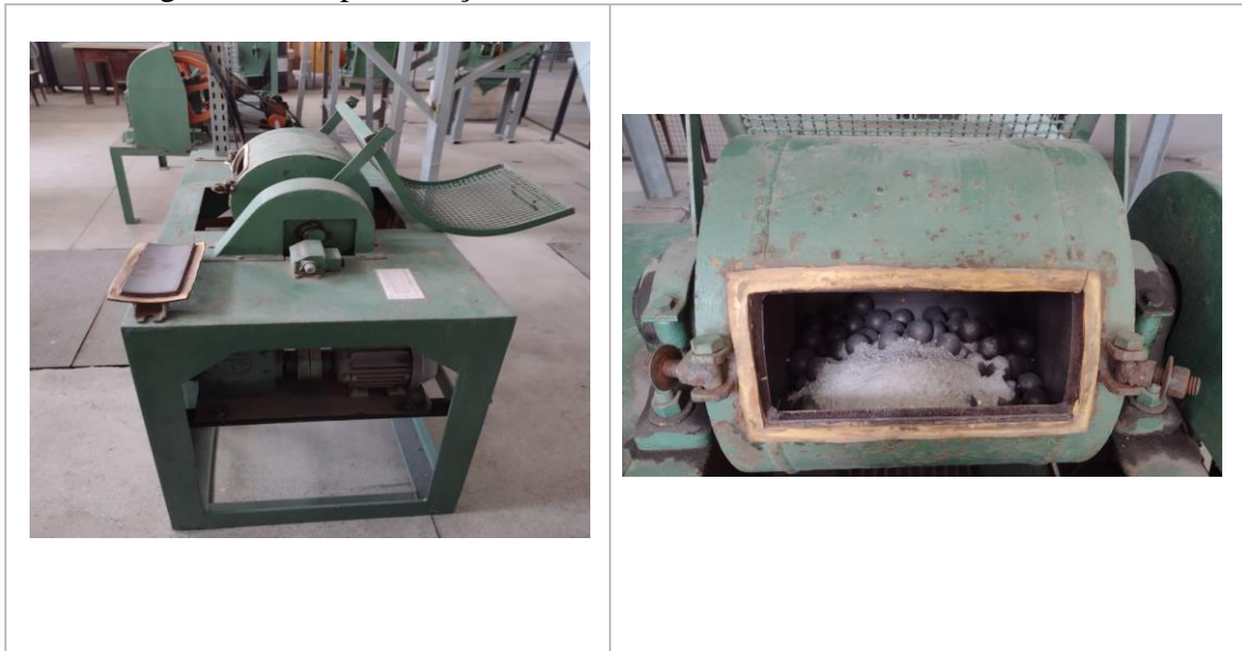
Figura 34 – Representação do moinho de bolas usado no ensaio de WI
