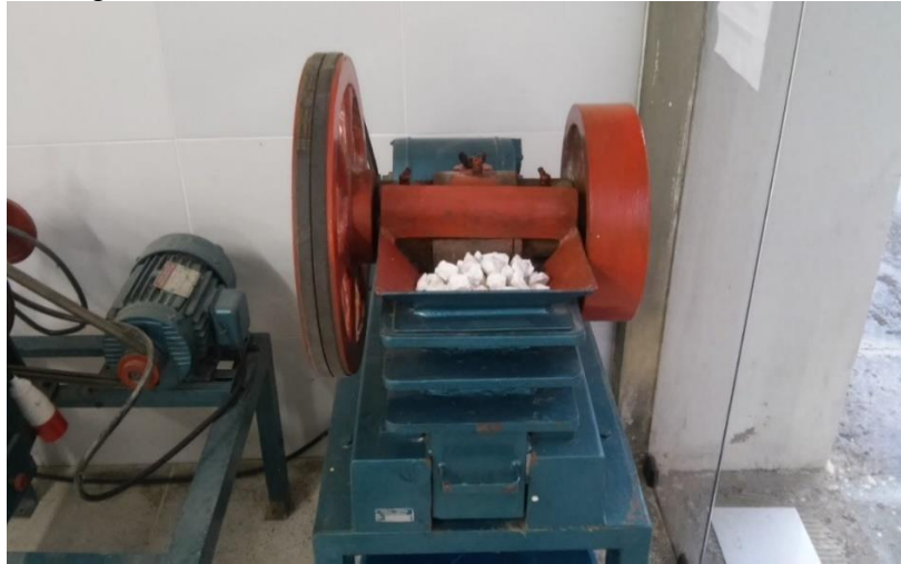
Figura 35 – Britagem do material no laboratório de tratamentos de minérios da UFCG
