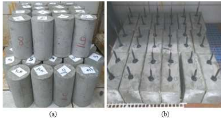
Figura 6 - Corpos de Prova Cilíndricos (a) e Prismáticos (b): Acondicionados em Câmara Úmida
