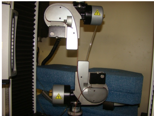
Fig. 1: Imagem da garra pneumática Instron durante o ensaio de tração dos cordoneis.
