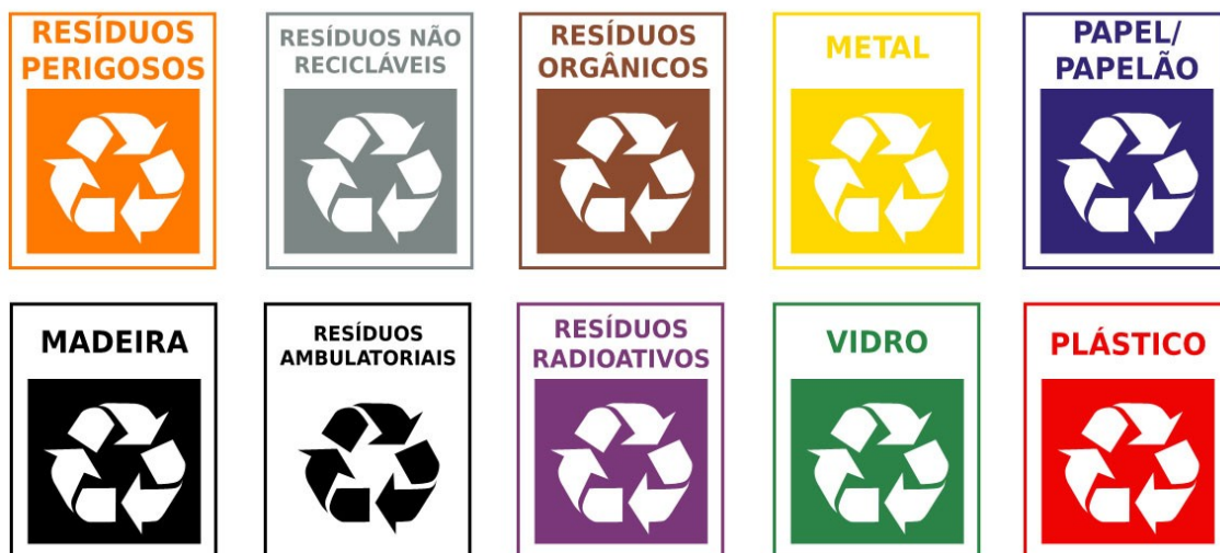
Figura 86: simbologia e cores adotadas para a identificação das caçambas para coleta seletiva
