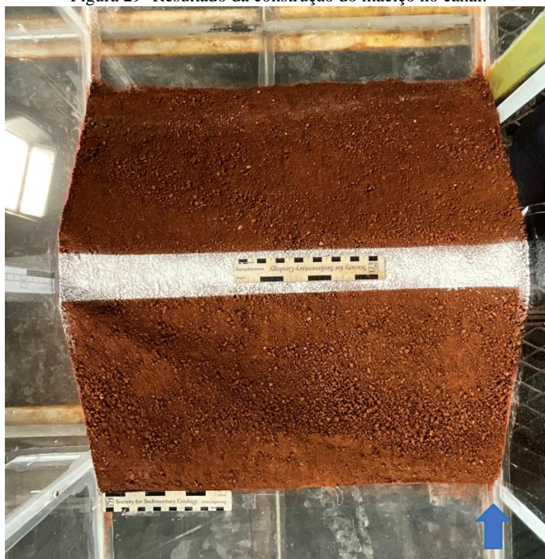
Figura 29- Resultado da construção do maciço no canal.
