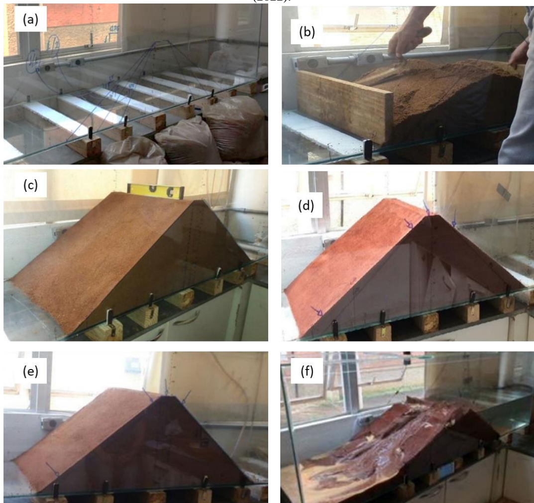
Figura 15 - Etapa de construção dos modelos físicos utilizados para elaboração do trabalho do Daniel et al. (2022).
