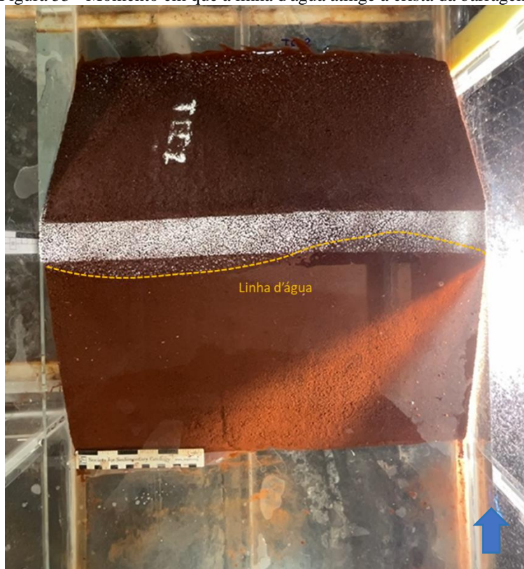
Figura 53 - Momento em que a linha d'água atinge a crista da barragem.
