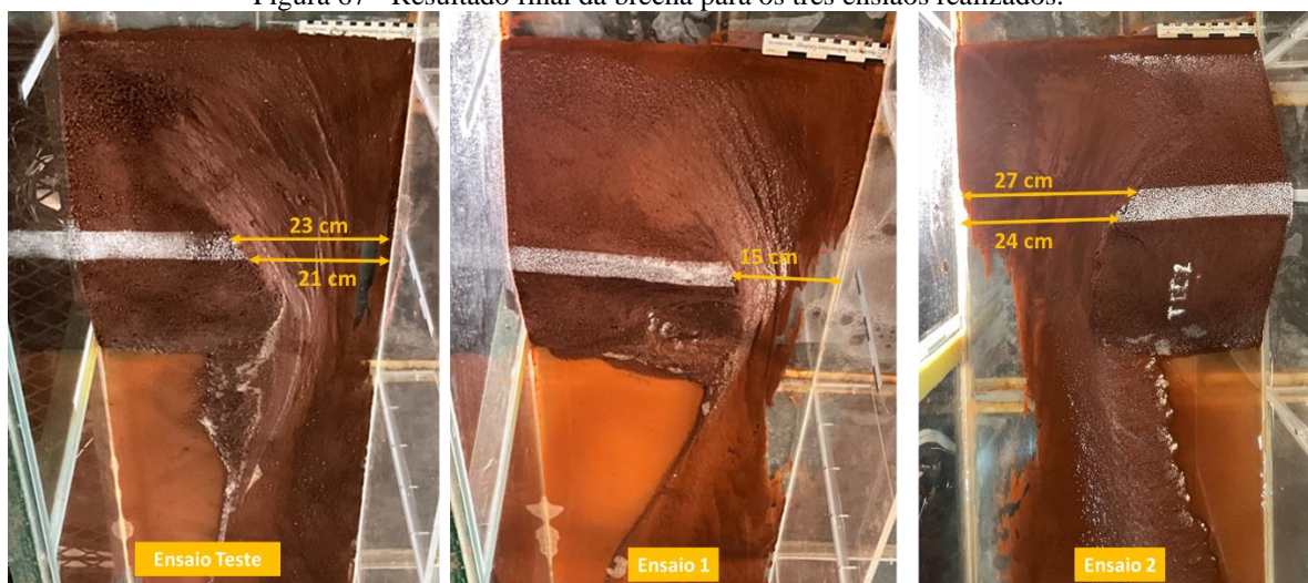
Figura 67 - Resultado final da brecha para os três ensaios realizados.
