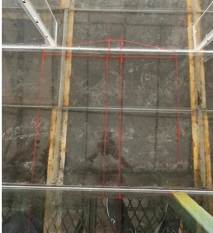
Figura 27- Desenho da geometria do maciço no canal de acrílico.
