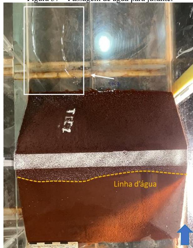
Figura 57 – Passagem de água para jusante.
