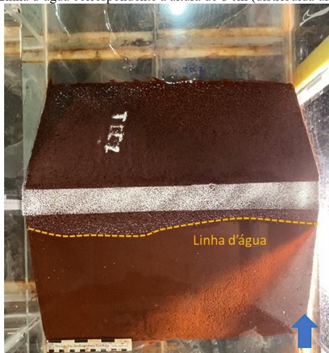
Figura 52 -Linha d'água correspondente à altura de 8 cm (distribuída uniformemente no maciço).
