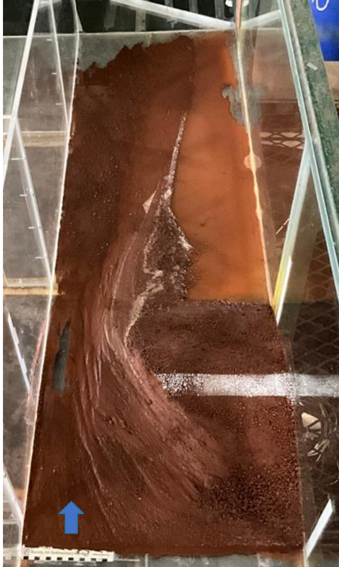
Figura 38 – Resultado do maciço após a ruptura e esvaziamento completo do reservatório.
