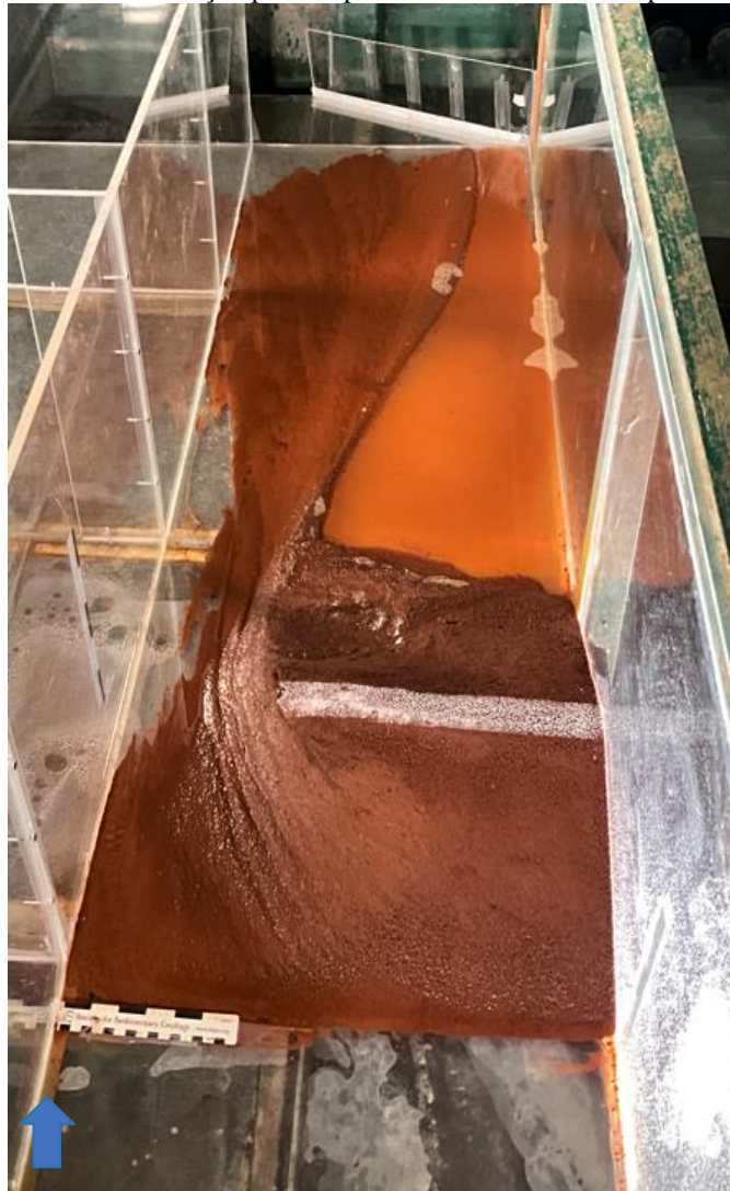
Figura 48 - Resultado do maciço após a ruptura e esvaziamento completo do reservatório.
