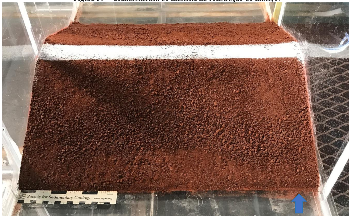
Figura 30 – Granulometria do material na construção do maciço.
