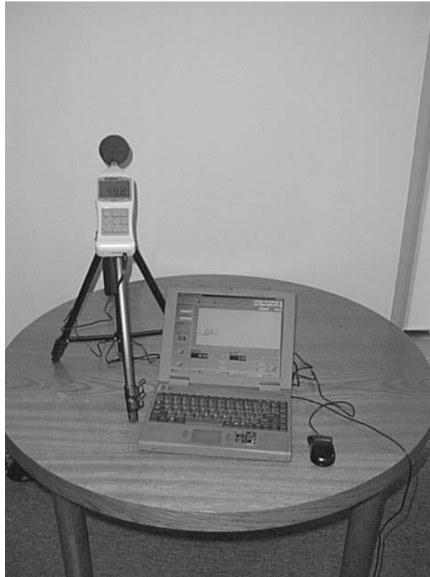
Figura 19: medidor de nível de pressão sonora, tripé, DataLogger e Notebook usados nos pontos de medição
