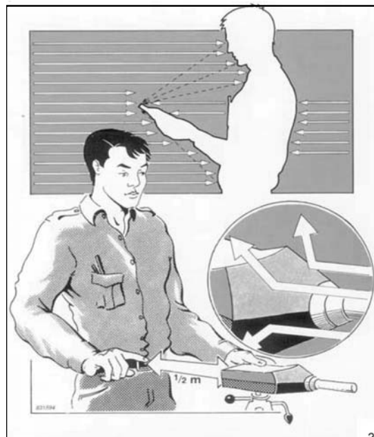
Figura 17: influência do corpo e posição do operador nas medições acústicas (Fonte: BRÜEL & KJÆR, 1984)
