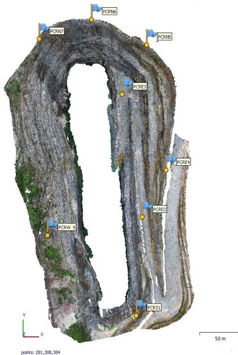
Figura 14: Nuvem de pontos final, vista superior, com pontos de controle. Fonte: Elaboração própria.
