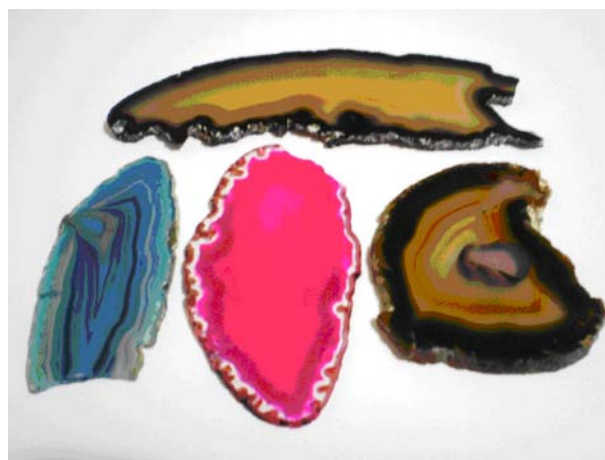
Figura 5: Chapas de ágata tratadas por tingimento.
