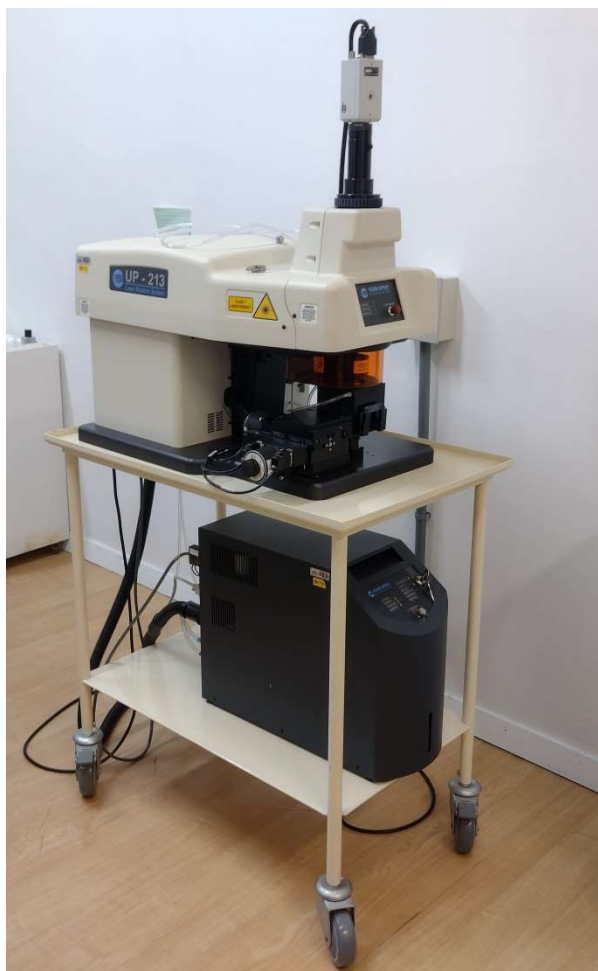
Figura 3: Plataforma de ablação a laser (Laser ablation - LA), New Wave UP213, utilizada para obter os dados apresentados nesta tese. Fonte: arquivo pessoal.
