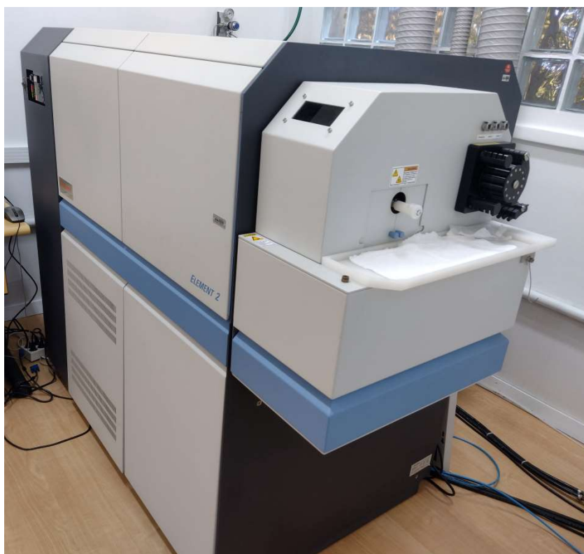
Figura 2: Equipamento ThermoFinnigan Element2 sector field ICP-MS, utilizado para obter os dados apresentados nesta tese. Fonte: arquivo pessoal.
