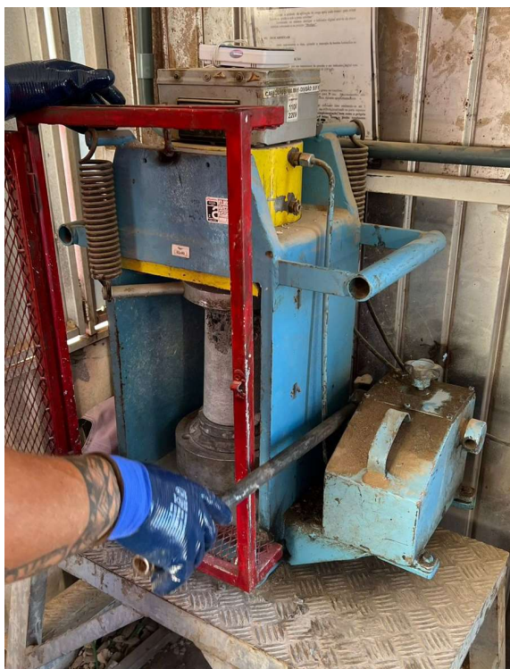
Figura 40: Retirada do corpo de prova ensaiado da prensa manual (Fonte: o autor).
