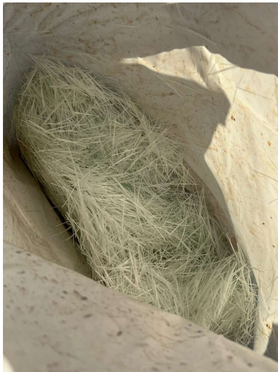
Figura 39: Fibra de vidro usada como adição no concreto (Fonte: o autor).
