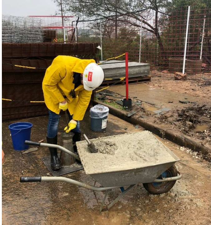
Figura 36: Realização do ensaio de slump (Fonte: o autor).
