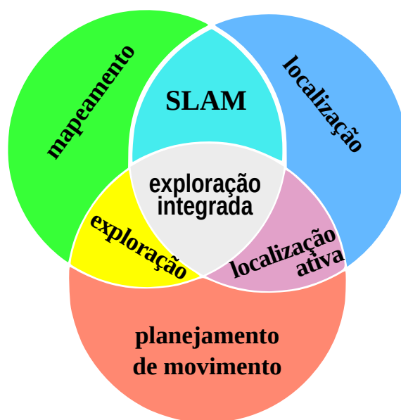
Figura 2.1 – Problemas fundamentais da robótica móvel e suas interseções. Figura adaptada de Makarenko et al. (2002).
