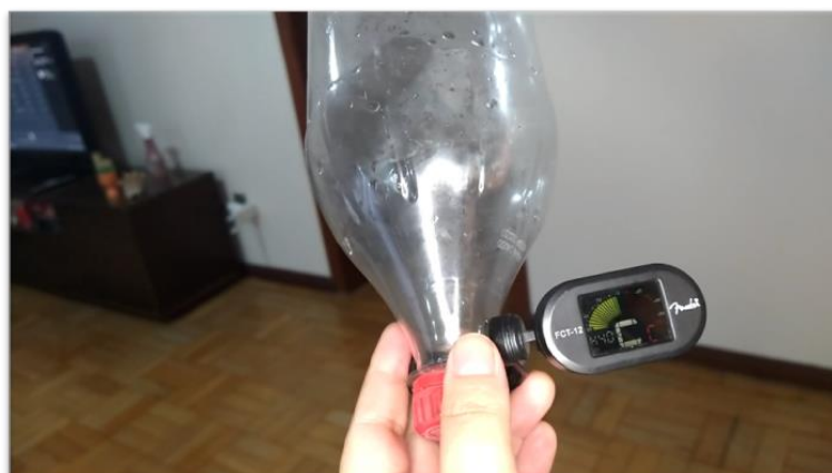
Figura 6 – Fixação do afinador de violão na parte superior da garrafa. Fonte: Arquivo pessoal
