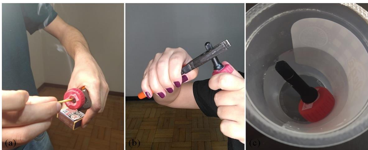
Figura 4 – Processo de fixação da válvula: (a) aquecimento do furo, (b) encaixe da válvula na tampa, (c) resfriamento do conjunto (tampa e válvula). Fonte: Arquivo pessoal
