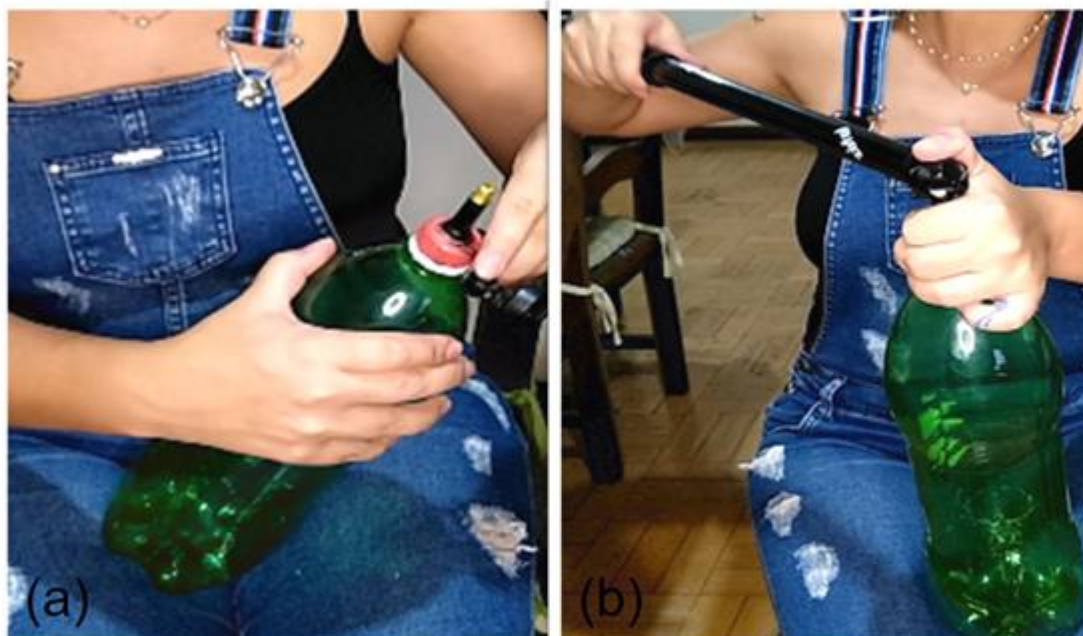
Figura 5 – Preenchimento da garrafa com ar comprimido: (a) colocação da tampa para fechamento da garrafa, (b) preenchimento com ar-comprimido através da Bomba para pneu de bicicleta. Fonte: Arquivo pessoal
