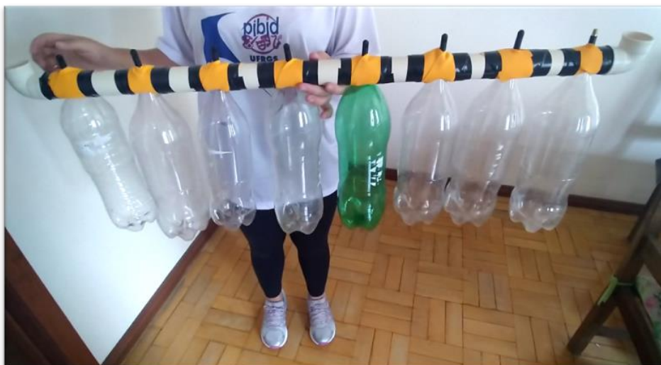
Figura 9 – Garrafas fixadas na base de cano PVC. Fonte: Arquivo pessoal
