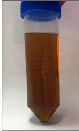
**Figura 11:** Amostra de pontos de carbono após a despolimerização com  $\text{KMnO}_4$  (CD-BK8,54)
