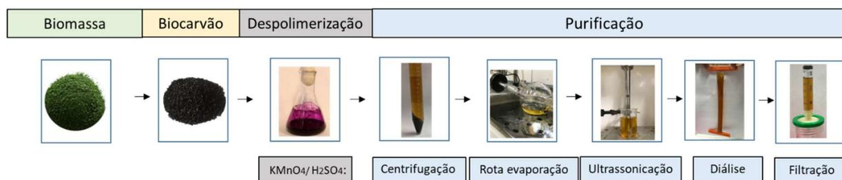
**Figura 6:** Ilustração esquemática da etapa de síntese de pontos de carbono
