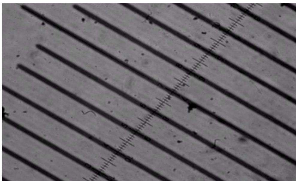
Figura AI.7 - Imagem com câmara Watec 902H com objetiva 100x, ocular 10x, lente da câmara ( $f=16\text{mm}$   $F=1.6$ ) e espaçador da câmara.
