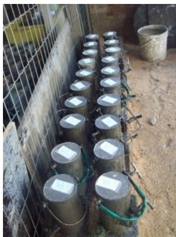
Figura 14: corpos de prova moldados
