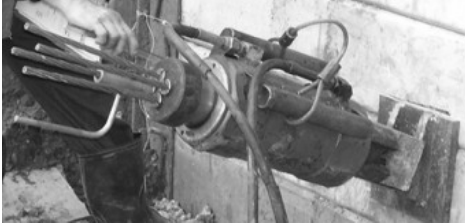
Figura 8: macaco hidráulico de protensão (GEODACTHA ENGENHARIA DE SOLOS E FUNDAÇÕES LTDA, 2006)
