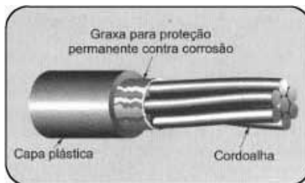
Figura 7: bainha plástica de protensão (ENGETEC TECNOLOGIA NA ENGENHARIA E PROTENSÃO LTDA, 2002)
