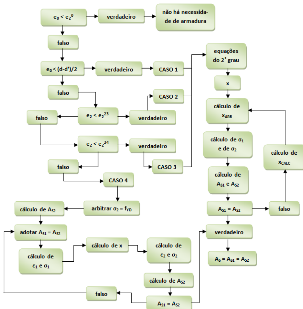
Figura 14: fluxograma para o dimensionamento de armaduras simétricas.
