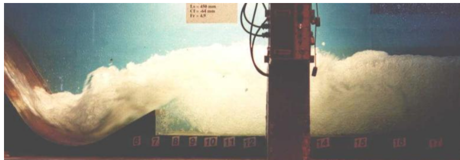
Figura 9: ressalto hidráulico no dissipador tipo concha de arremesso (ESTRUTURAS..., 2010)
