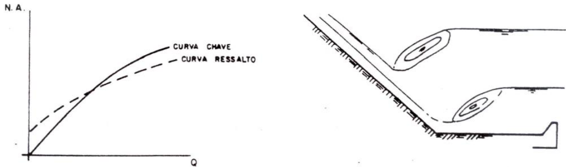
Figura 31: relação da curva chave com a curva do ressalto quando esta tem comportamento diferente em função da vazão e demonstração dos ressaltos possíveis de serem formados (TAMADA, [1991], p. DIS-3)
