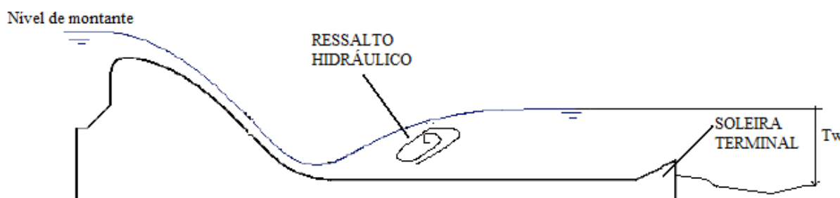
Figura 18: bacia de dissipação por ressalto hidráulico tipo I (adaptado de WIEST, 2008, p. 6)
