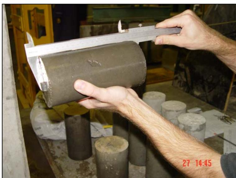
Figura 5.2: medição dos corpos-de-prova
