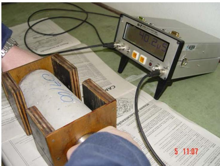
Figura 2.3: aspecto de execução do Ensaio de VPU.
