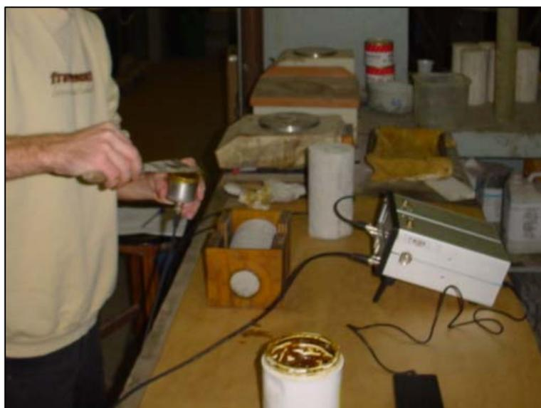
Figura 5.5: aplicação de acoplante sobre os transdutores.
