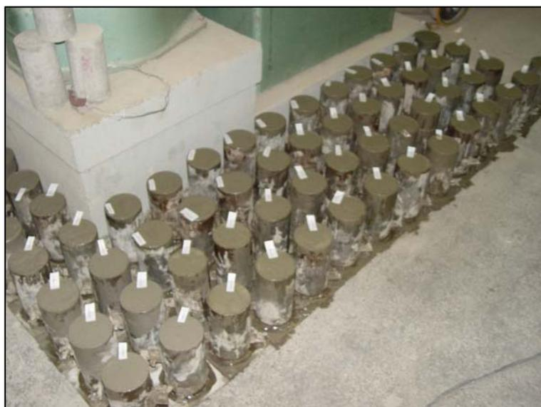
Figura 5.1: corpos-de-prova moldados após a concretagem
