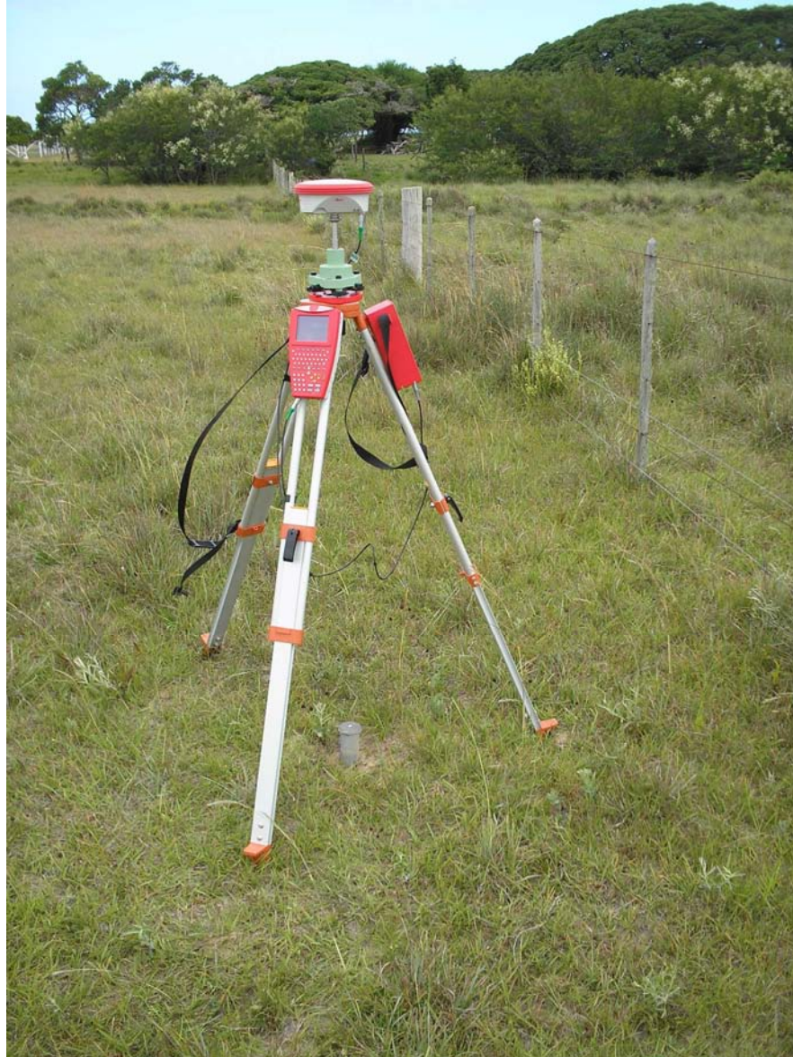
Fig. 19 – Marco classe C1, base para o transporte de coordenadas e apoio básico ao levantamento georreferenciado.
