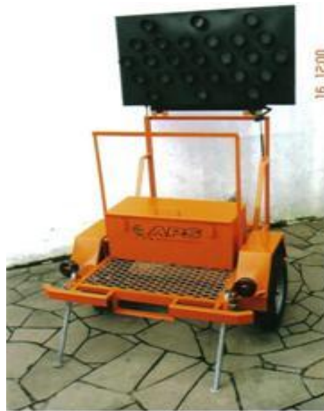
Figura 13: Dispositivo luminoso rebocável de sinalização de obras
