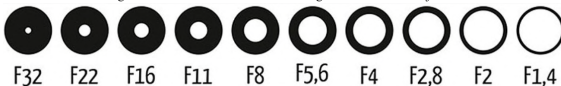
Figura 7: Diferentes aberturas do diafragma de uma lente objetiva.
