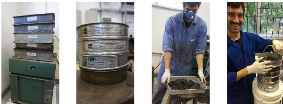
Figura 3: Ensaio de classificação granulométrica.
