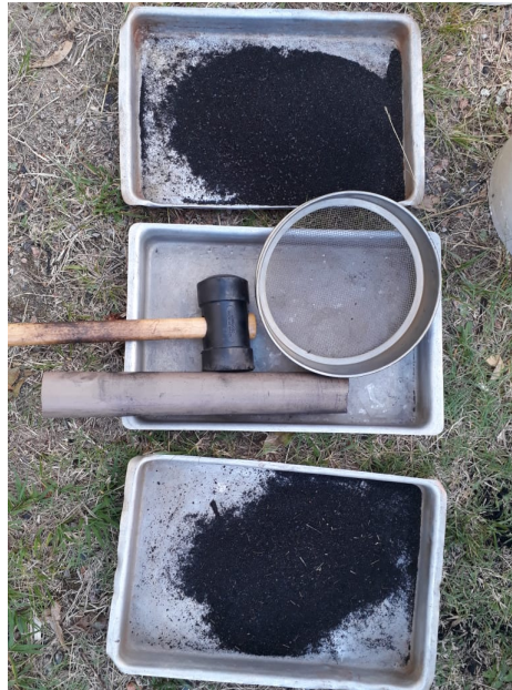
Figura 8: Equipamentos utilizados na amostragem de tecnossolos.
