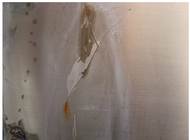
Figuras 8 e 9 – Trincas na chapa do defletor. Vista do lado frontal.
