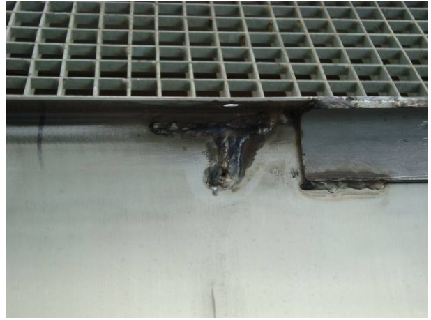
Figura 7 (esquerda) – Fratura ocorrida na porção intermediária do elemento semi-circular. Reparada com solda e coberta por um reforço. Figura 8 (direita) – Fratura na porção intermediária de elemento semi-circular, reparada com solda.
