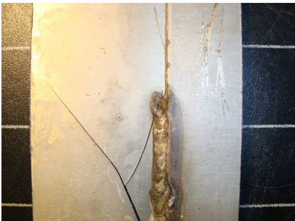
Figuras 6 e 7 – Ocorrência de trincas junto aos cordões de solda. Vista pelo lado posterior da chapa, mostrando o reforço instalado.
