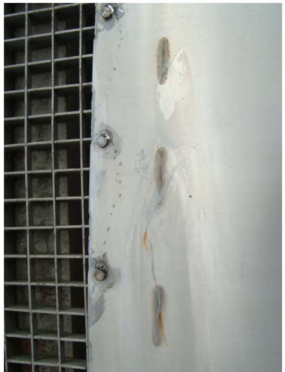
Figuras 2 e 3 – Ampliações da região fraturada.
