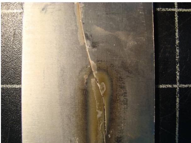
Figuras 8 e 9 – Trincas na chapa do defletor. Vista do lado frontal.
