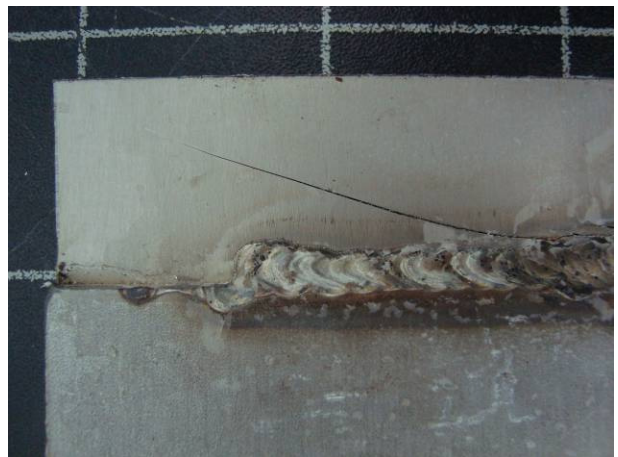
Figuras 6 e 7 – Ocorrência de trincas junto aos cordões de solda. Vista pelo lado posterior da chapa, mostrando o reforço instalado.
