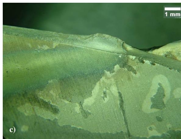
Figuras 6.3 (a) e (b) – Marcas de praia encontradas na superfície da fratura. Figura 6.3 (c) – Fratura na região do cordão de solda.
