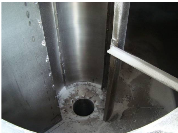
Figuras 2 e 3 – Conjunto defletor em seu local de instalação.
