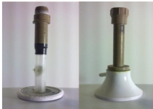
Figura 5- Geometrias de câmara de saída: achatada (e) e campânula (d)
