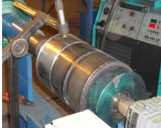
Figura 5.4 – Tambor enrolador posicionado no dispositivo automático de soldagem
