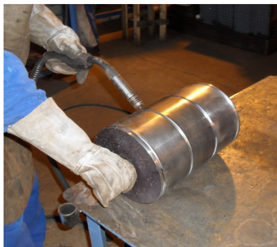
Figura 5.3 – Tambor enrolador posicionado sobre a bancada
