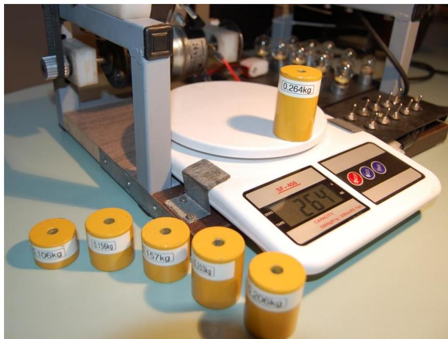
Figura 2 – Balança em teste de incerteza de medição
