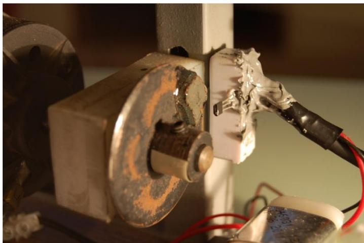
Figura 4 – Rotor montado no dinamômetro
