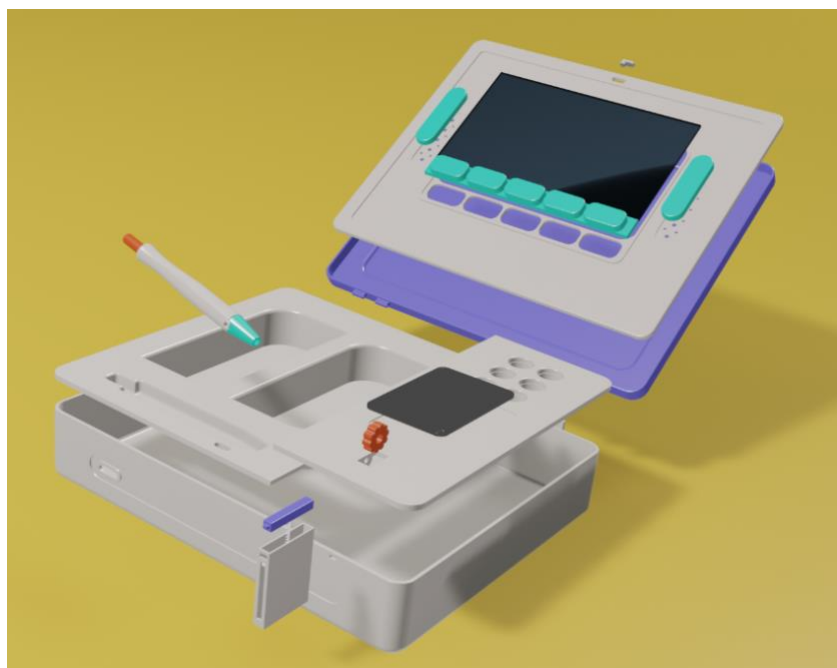
Figura 52: Lino Control – Vista explodida dos componentes
