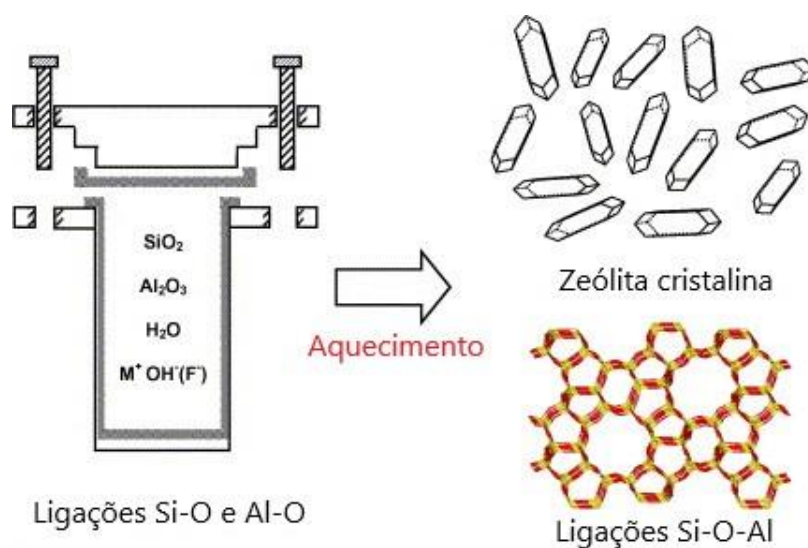
Figura 6. Ilustração esquemática da síntese hidrotérmica da zeólita ZSM-5.
