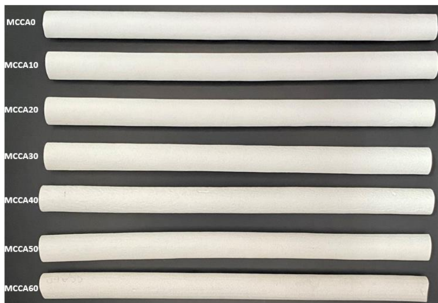
Figura 5.10 - Imagem das membranas cerâmicas tubulares preparadas com diferentes teores de alumina e de cinza da casca de arroz, pela técnica de centrifugal casting (8000 rpm e 10 minutos). A temperatura de sinterização foi de 1200 °C.
