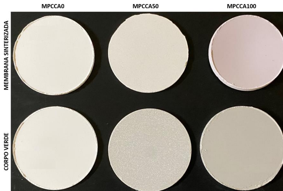
Figura 5.6 - Imagens das membranas cerâmicas planas sinterizadas a 1200 °C e os respectivos corpos verdes.
