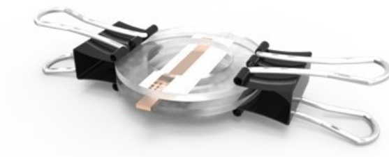
Figura 25 – Célula de volatilização
