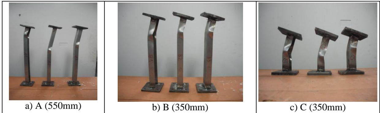
Figura-6.3: diferença do local de falha ao longo do comprimento nos corpos de prova testados
