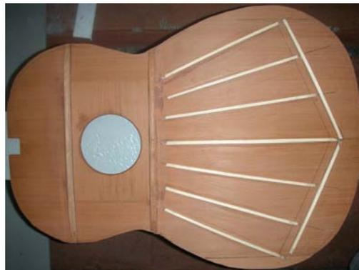
Figura 4 – Detalhe do padrão de reforço do TC
