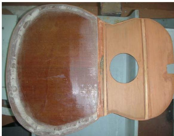
Figura 6 – Detalhe do tampo reforçado com Nomex®
