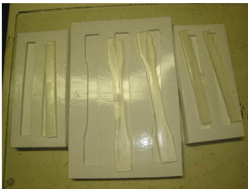
Figura 10 – Corpos de prova após e moldes de silicone
