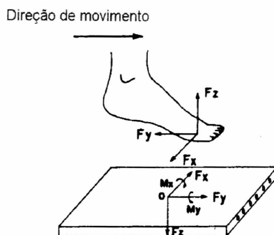
Figura 3.1 – Decomposição da força atuante na superfície da plataforma de forças. Adaptado de Silveira Filho, 1997
