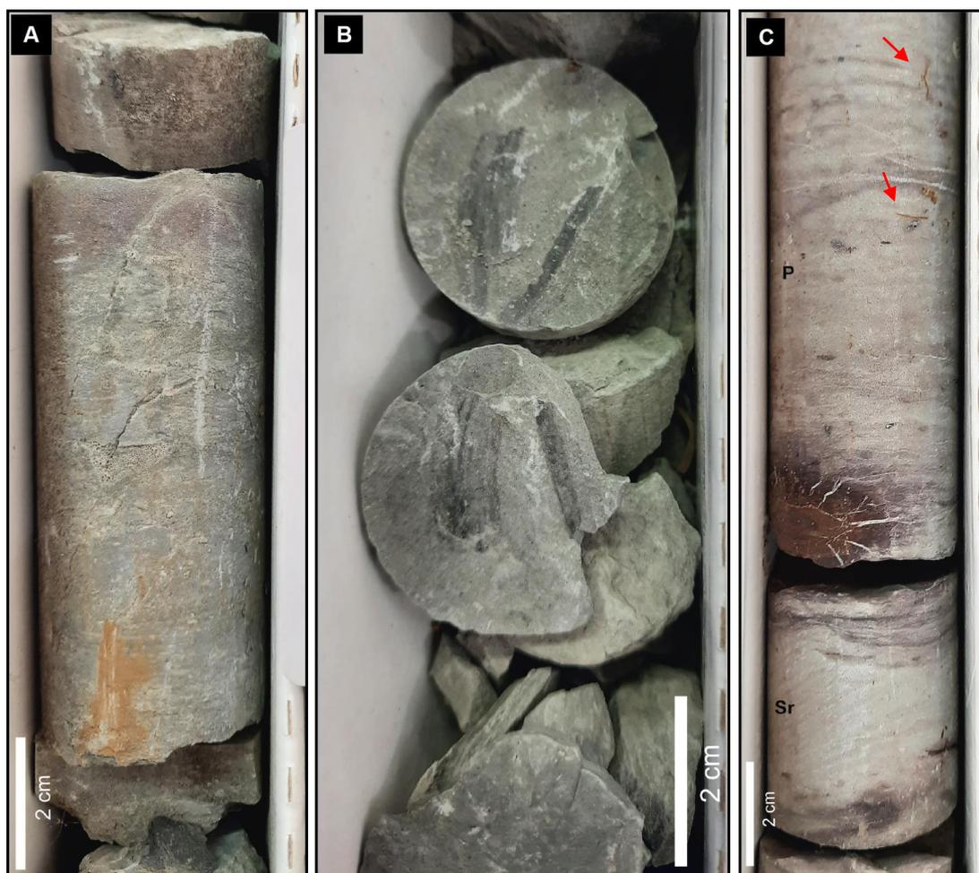
Figura 13. Fotos macroscópicas das principais fácies descritas no testemunho 5-CA-20-RS. (A) *Fl(c)*; (B) Fácies *Fl(p)* apresentando impressões de fósseis vegetais; (C) Arenito fino com marcas onduladas de corrente (*Sr*) na base e nível com feições pedogênicas (*P*) na porção superior, apresentando mosqueamentos, texturas preenchidas por calcita e marcas de raízes (seta vermelha).
