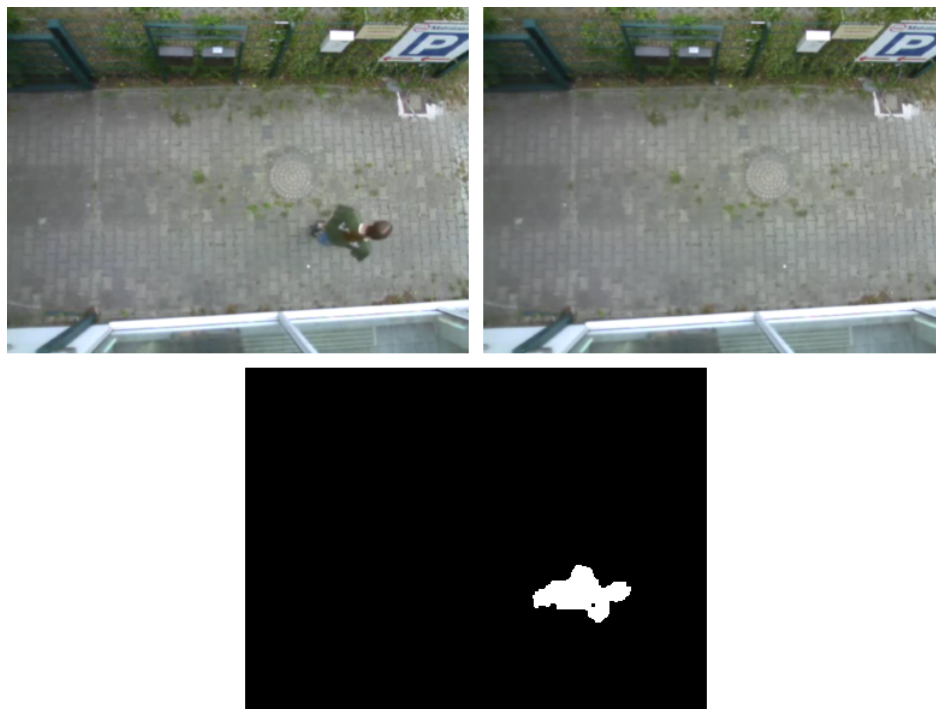
Figura 2.2: Exemplo de Background Subtraction
