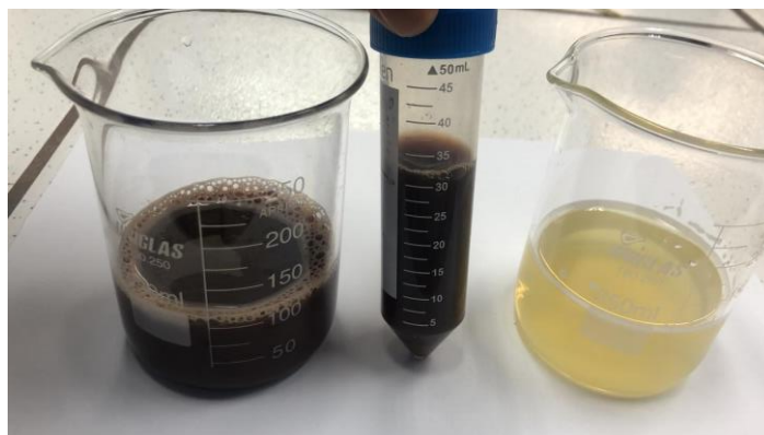
Figura 5: Soluções para construção da curva de calibração, à esquerda a solução de acácia, no centro o efluente coletado e à direita a solução de tanigan.
