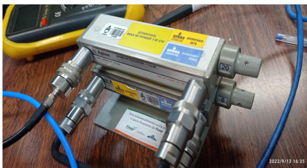
Figura 10 – Foto do atenuador variável e dos cabos coaxiais utilizados nos experimentos de laboratório.
