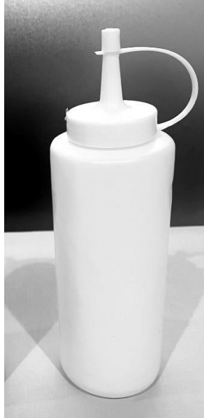
Figura 42 — Bisnagas de plástico utilizadas para vazamento do silicone.
