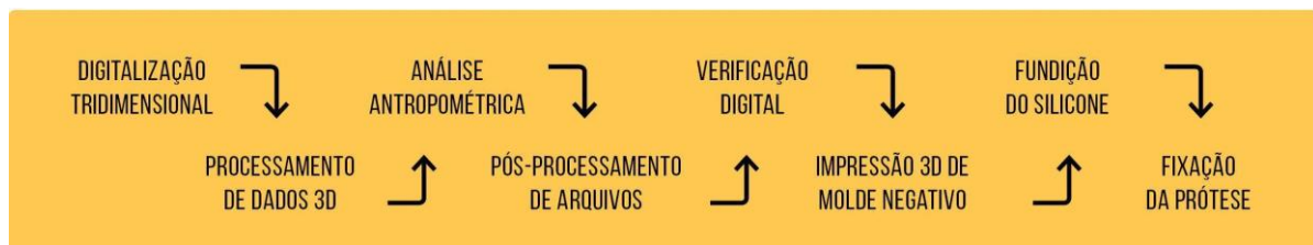
Figura 5 — Etapas da metodologia para o desenvolvimento de uma prótese estética de orelha.
