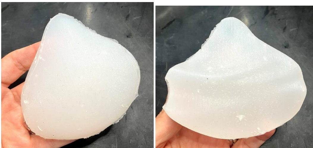
Figura 44 — Protótipo B em escala reduzida com silicone final Ecoflex Shore OO 10.
