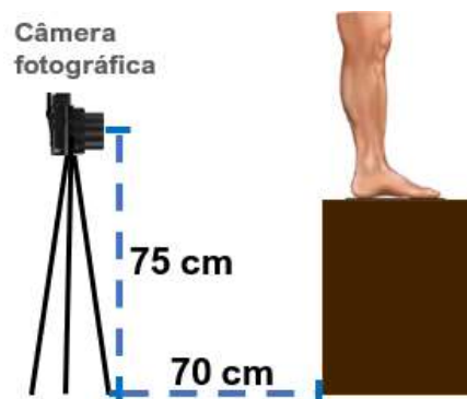
Figura 1 – Posicionamento da câmera em relação ao indivíduo no ambiente de coleta para avaliação por fotogrametria.
