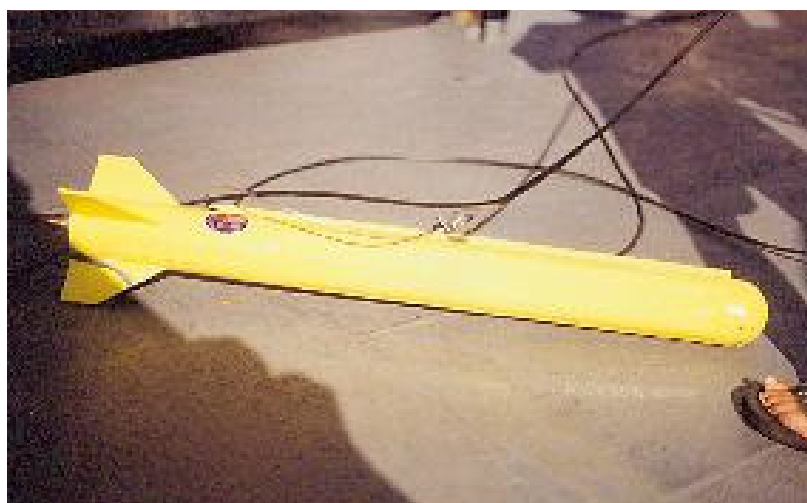
Foto 1 - Transdutor do Sonar de varredura lateral utilizado no projeto AREIA-PT.
