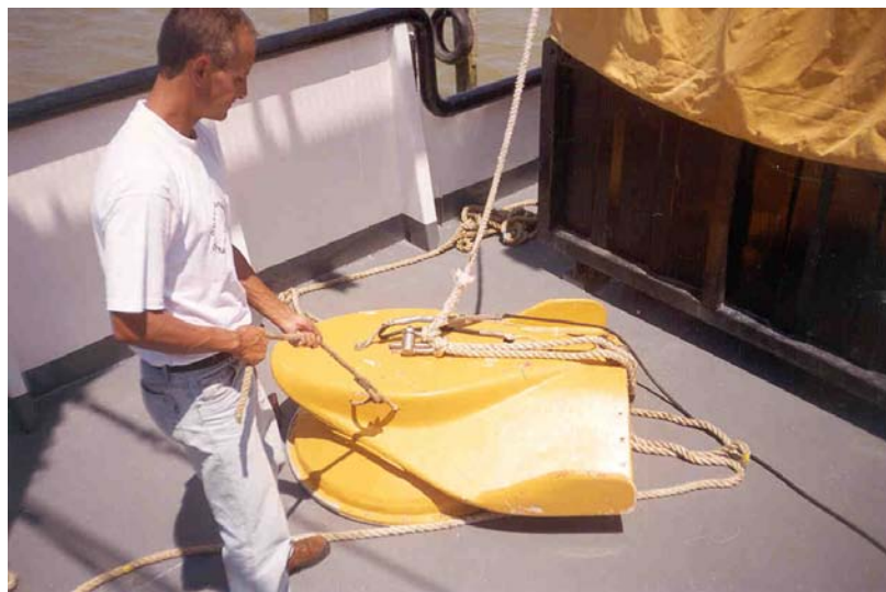
Foto 2 - Transdutor do sistema Boomer utilizado no projeto AREIA-PT.
