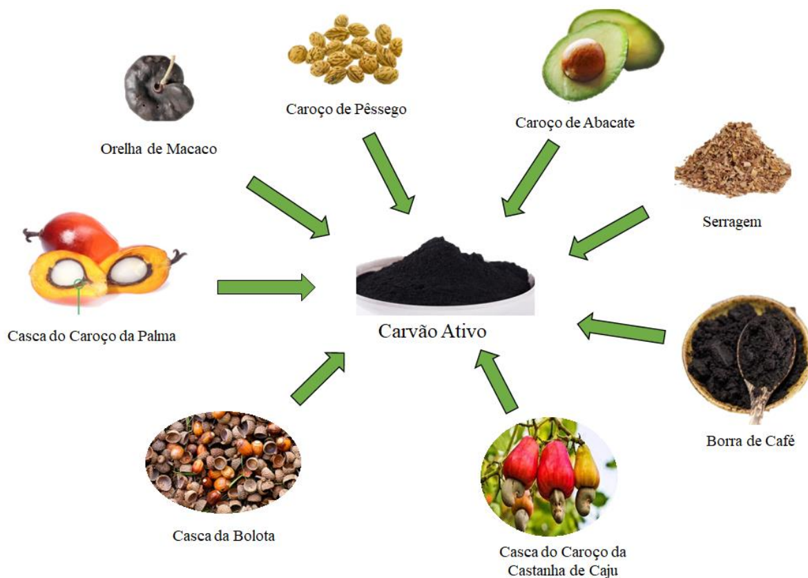
Figura 3. Exemplos de biomassas que podem ser utilizadas como fonte de carbono para a produção de carvão ativo. Fonte: adaptada de Wong e Colaboradores [41].
