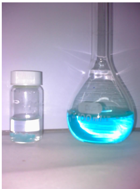
Figura 66: Solução de \text{CuSO}_4 \cdot 5\text{H}_2\text{O} cobre antes (balão volumétrico) e após (cubeta) a adição de determinada quantidade de polieletrólito.
