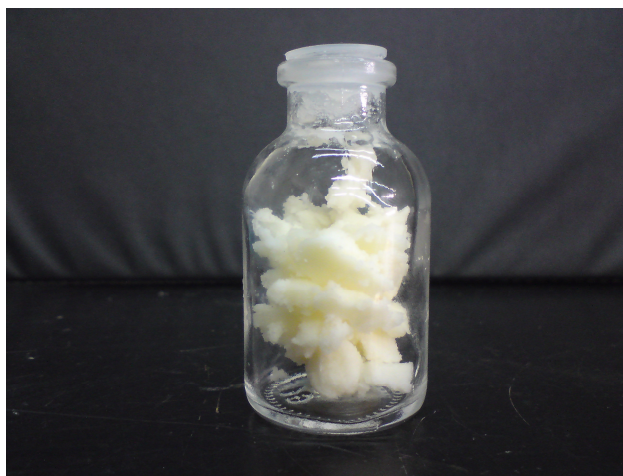
Figura 14: Ácido oleico epoxidado.
