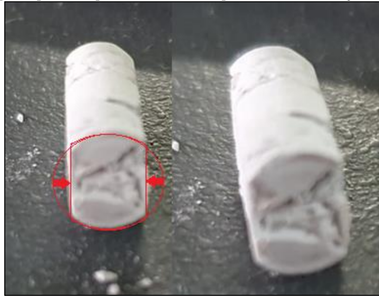
Figura 17 - Corpos de prova em que o teste foi interrompido devido à deformação, sem ruptura frágil
