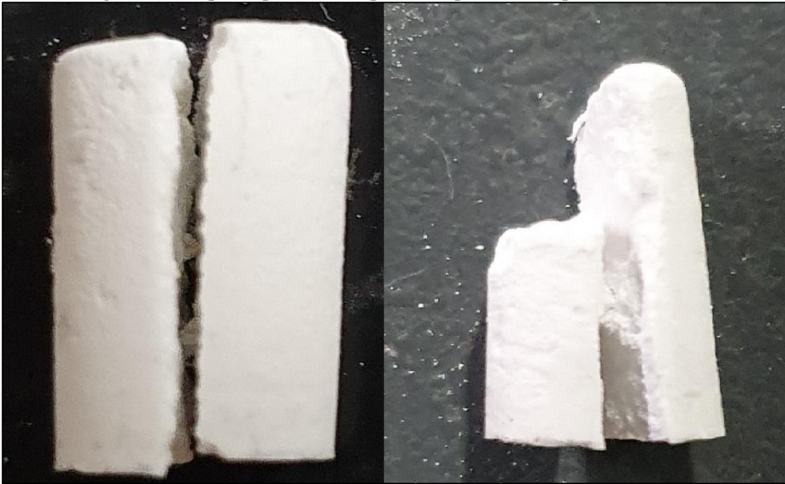
Figura 18 - Corpos de prova do compósito rompidos em compressão diametral
