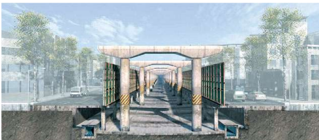
Figura 3.7 – Corte da visão panorâmica da desmontagem tabuleiros de viadutos.
