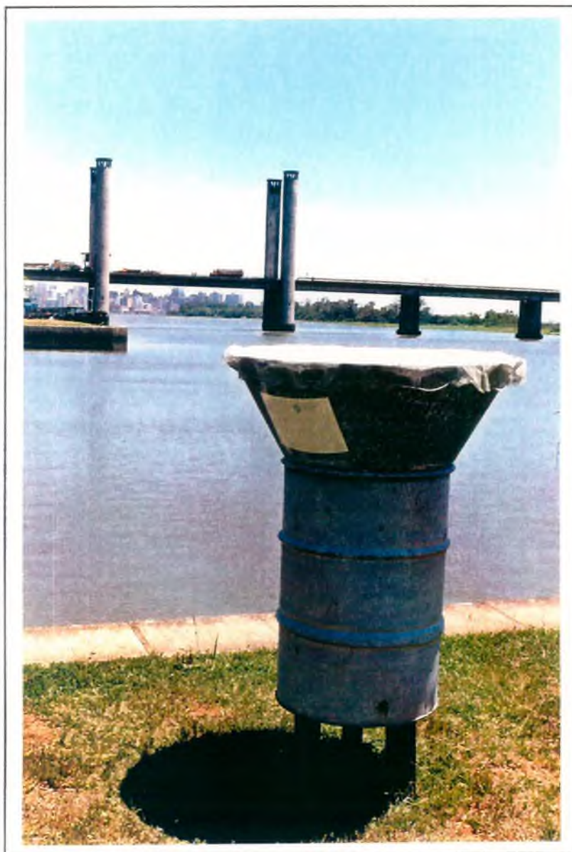
Figura 4.3 Amostrador Utilizado para a Coleta da Água da Chuva(Posto Batalhão de Polícia Ambiental)
